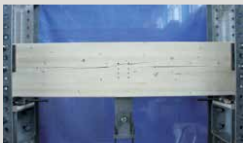
Fissuration d'une poutre: rupture en traction perpendiculaire d'un assemblage transversal avec des broches sollicitées perpendiculairement au fil – banc d'essais et éprouvette de l'EPF Zurich. (Photo Robert Jockwer, IBK de l'EPFZ)
