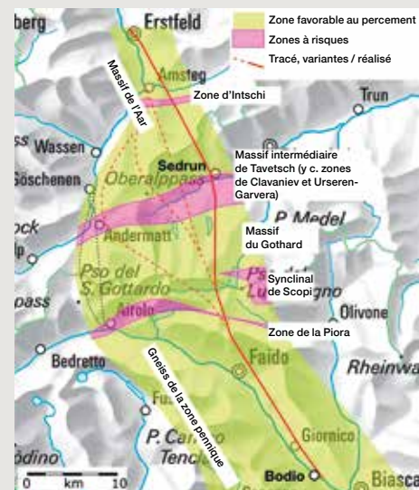
La voie la plus courte n'est pas toujours la meilleure: le tracé du tunnel de base du Gothard résulte de nombreuses contraintes géologiques et topographiques. Illustration: Peider Konz (1993)/ Office fédéral de la topographie
