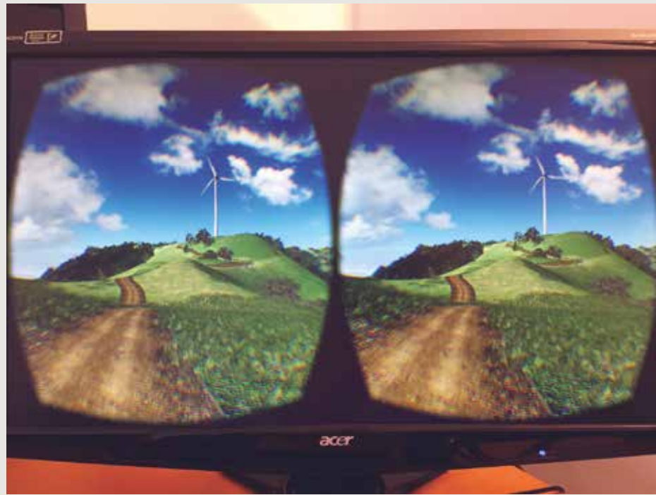
Scène VR d'un parc éolien conçue à l'aide du logiciel CryEngine et basée sur des données SIG. On peut observer ici le mode d'écran partagé pendant une présentation avec les lunettes VR d'Oculus Rift SDK2. (foto: Wissen Hayek et al. (2016) https://doi.org/10.14627/537612012
