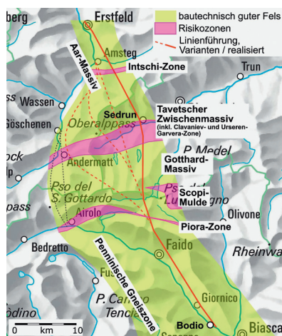
Die Linienführung des Gotthard-Basistunnels berücksichtigt Aspekte von Geologie, Topografie, Stauseen und Bautechnik.
